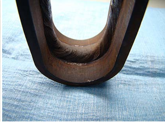
(d) Compressive side of U-bend after exposure
