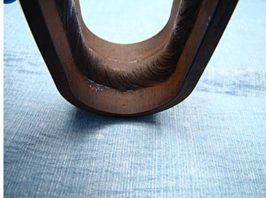
(d) Compressive side of U-bend after exposure
