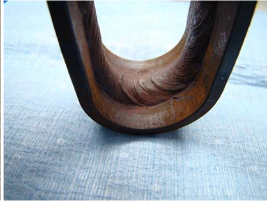
(d) Compressive side of U-bend after exposure
